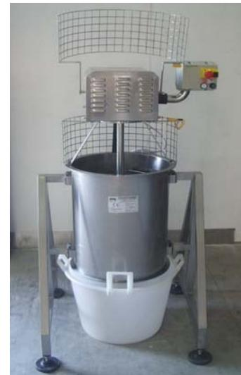
**Tagliacagliata a lame orizzontali** del tipo "a disco rotante **teflonato**", con struttura in tubolare AISI 304.
