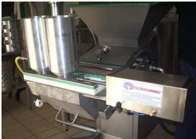
**Attrezzo-slitta formatore manuale a tazze** per la produzione di caciocavallo e provole. Da applicare all'uscita camera coclee della macchina formatrice automatica.
